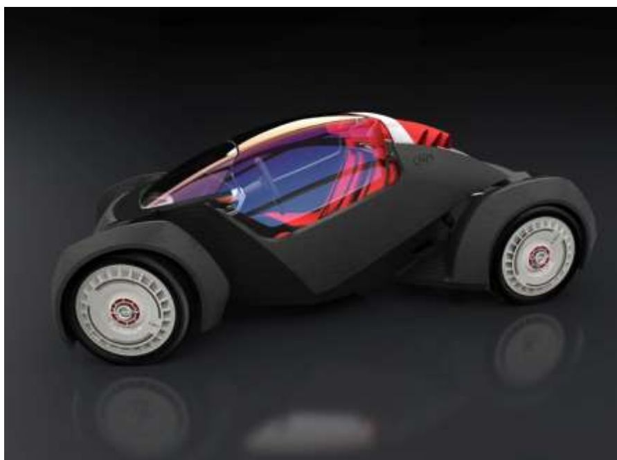
9-сурет- Strati-3D принтерде басылған әлемдегі алғашқы сериялық автомоби
